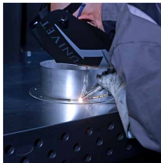
Mittels Laserschweißen verarbeitet die Riggenbach AG vielfältige Materialien wie Chromstahl, Alu, Stahl oder auch verzinkten Stahl.
